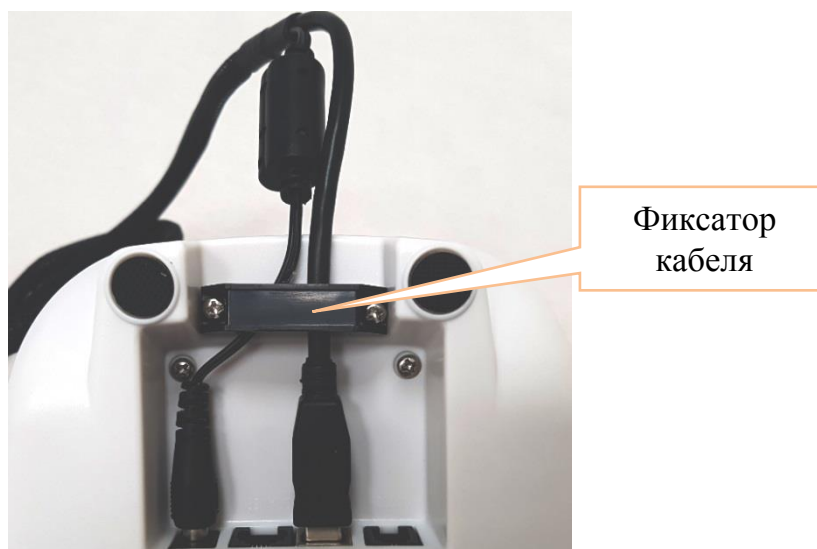
Рисунок 18 – Фиксирование соединительного кабеля принтера
