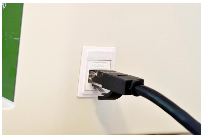
Рисунок 16 – Подключение к сети Ethernet
