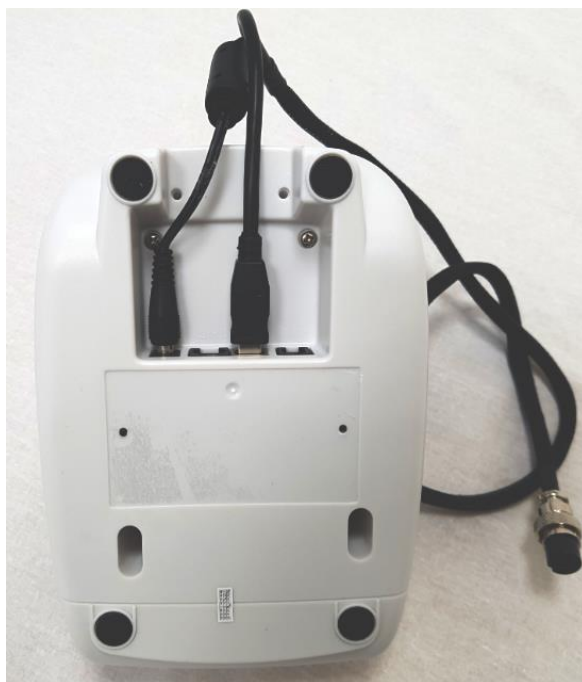
Рисунок 17 – Подключение соединительного кабеля к принтеру
