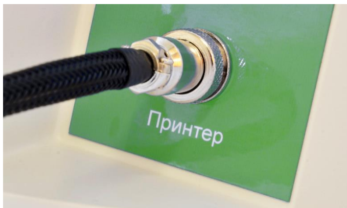
Рисунок 19 – Подключение соединительного кабеля принтера к КИК
